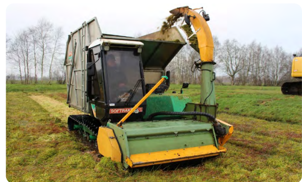
Abb. 2.11: Ernte von Torfmoos-Biomasse. Oben: Maschinelle Torfmoos-Ernte mit Mähkorb. Unten: Test-Ernte mit kettenbasierter Technik (Loglogic). Weitere Infos siehe Kapitel 7.2. Fotos: oben: P. Schroeder, unten: G. Gaudig.
