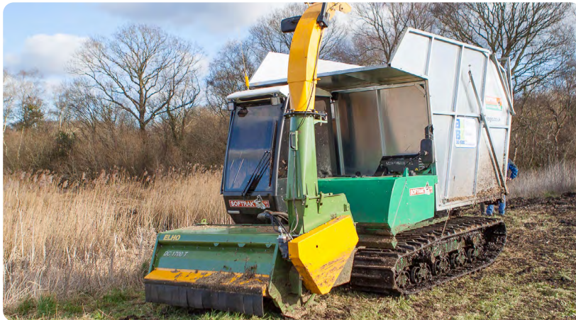
Abb. 2.8: Einstufiges Ernteverfahren: Erntetechnik für Häckselgut, Winterernte. Erntetechnik: Softrak 120 (Loglogic) mit ELHO Doppelhäcksler und 11 m 3 Bunker. Nur für Spezialkulturen oder in der Landschaftspflege geeignet. Foto: T. Dahms, 2021.
