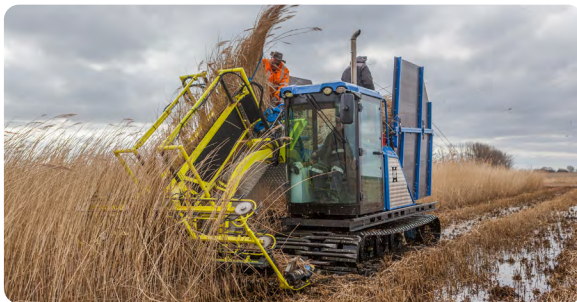
Abb. 2.6: Rohrwerbung mit Seiga und Raupentechnik von Hanze Wetlands auf Rügen. Beispiele für einstufige Ernteverfahren. Fotos: T. Dahms
