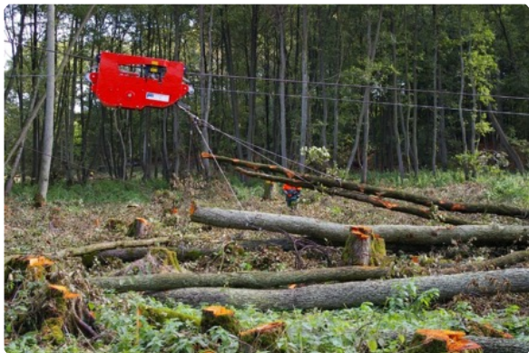
Abb. 2.12: Seilkran-Technik zur Bergung der manuell eingeschlagenen Stämme. Foto: P. Röhe.
