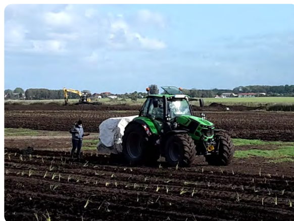
Abb. 2.3 a+b: Maschinelle Pflanzung von Rohrkolben mit einer Forstpflanzmaschine (Fotos: a) T. Dahms, b) A. Nordt, 2019). Erfolgt die Pflanzung vor Zuwässerung, d.h. im noch entwässertem Zustand, kann die Pflanzmaschinentechnik mit gängiger Transporttechnik zum Einsatzort gebracht werden, es bestehen dann keine speziellen Anforderungen an die Infrastruktur.
