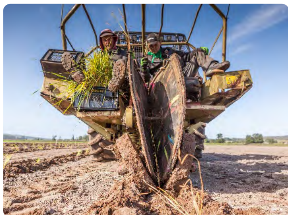
Abb. 2.3 a+b: Maschinelle Pflanzung von Rohrkolben mit einer Forstpflanzmaschine (Fotos: a) T. Dahms, b) A. Nordt, 2019). Erfolgt die Pflanzung vor Zuwässerung, d.h. im noch entwässertem Zustand, kann die Pflanzmaschinentechnik mit gängiger Transporttechnik zum Einsatzort gebracht werden, es bestehen dann keine speziellen Anforderungen an die Infrastruktur.
